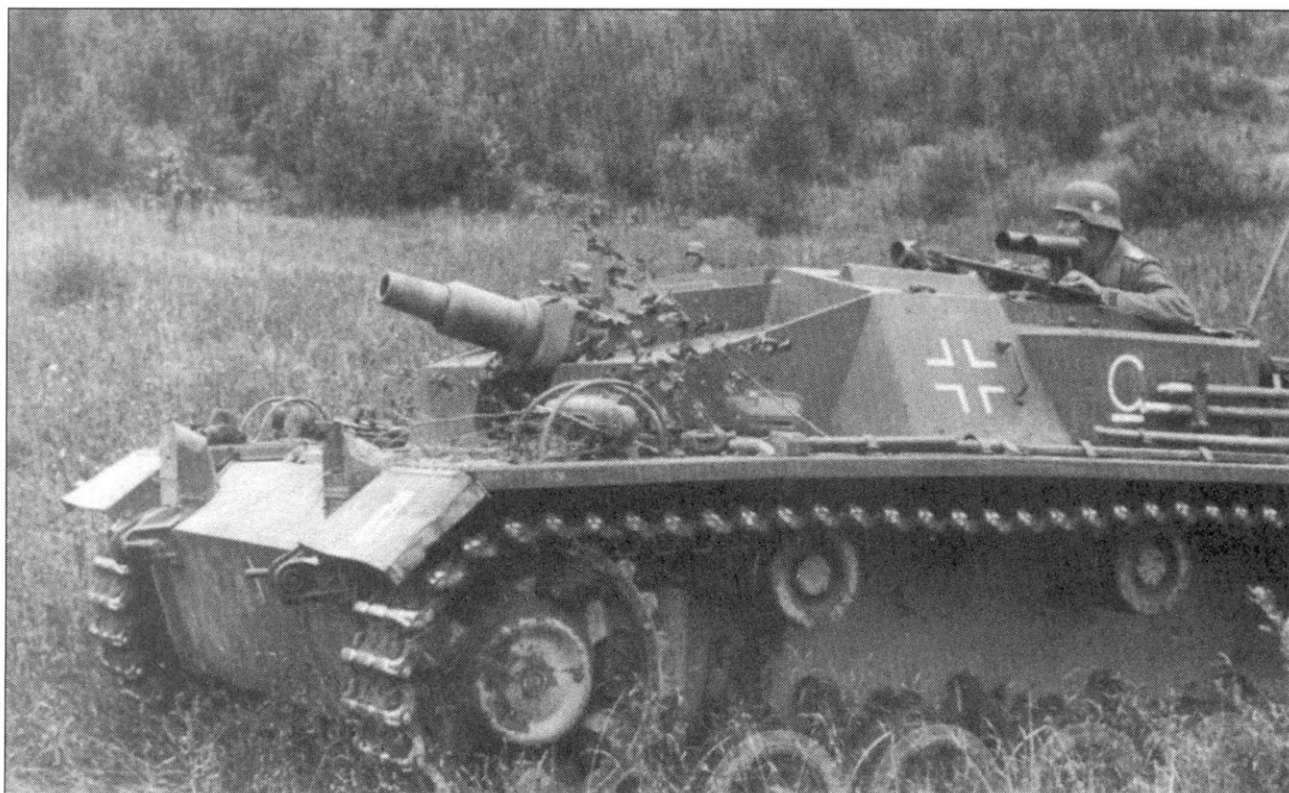
Хорошо видны изменения, произошедшие во внешнем облике штурмовых орудий StuG III Ausf. C/D по сравнению с предыдущими вариантами. В лобовом листе рубки отсутствует вырез под прицел, оптическая головка которого теперь выводится через верх боевого отделения. Командир использует для наблюдения обычный артиллерийский биноклярный перископический прибор. По написанному на крыле номеру шасси (90630) можно установить, что на снимке - штурмовое орудие StuG III Ausf. D.
