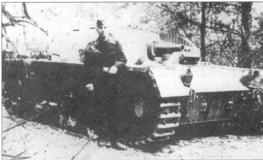
Вид спереди на пятый прототип штурмового орудия. Эта машина изготовлена на шасси танка PzKpfw III Ausf. B, корпус штурмового орудия выполнен из конструкционной стали средней твердости. Машина использовалась для испытаний, а затем в учебном процессе подготовки экипажей штурмовых орудий из-за отсутствия бронирования боевое использование прототипов исключалось. Обратите внимание на два круглых смотровых люка в лобовом листе корпуса, они были лишь на опытных машинах.
