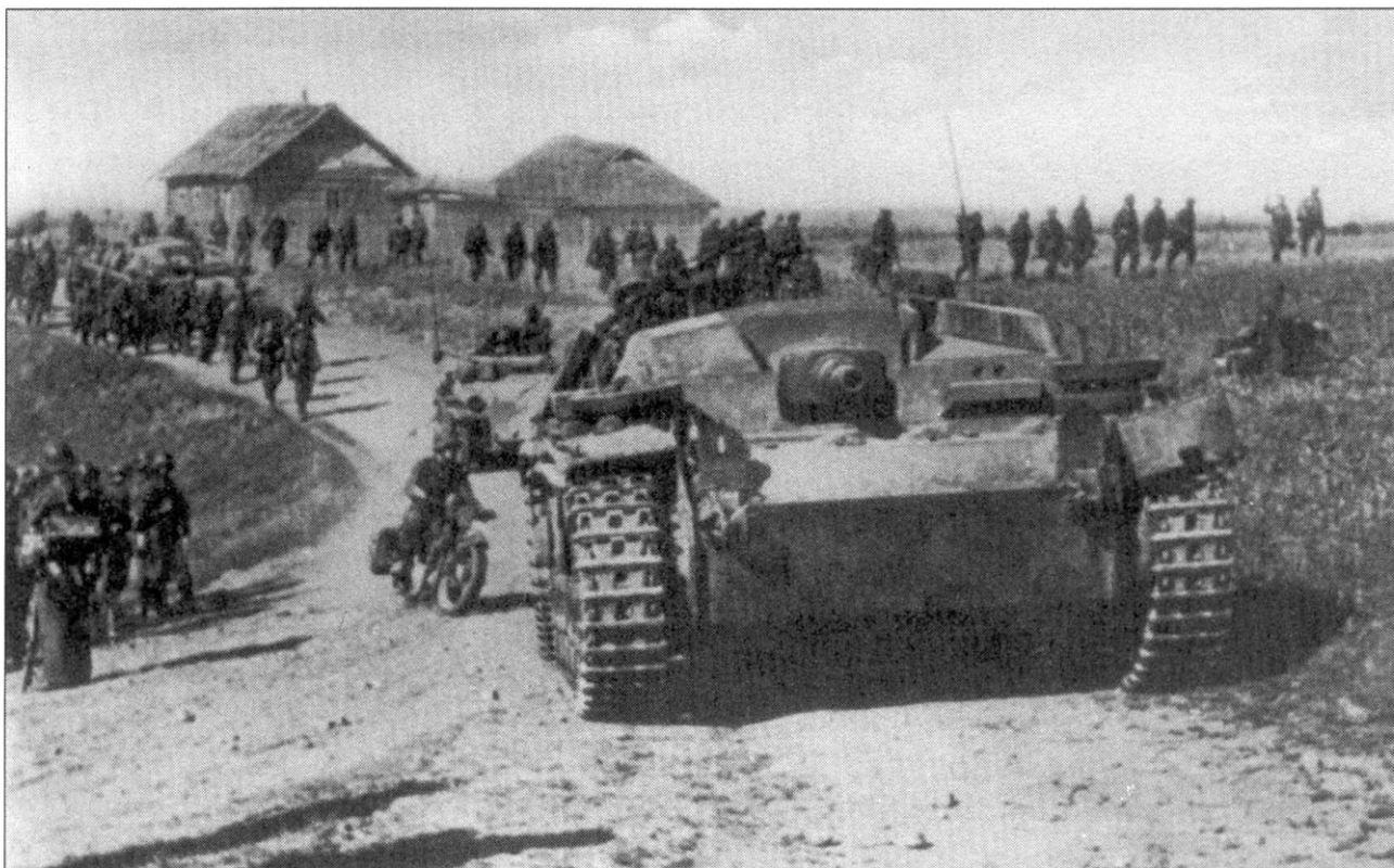
Немецкая мотопехота при поддержке Sturmgeschütz Ausf. B продвигается по украинскому селу, 1941 г. Машина сильно запылена, крылья помяты, на левом и правом крыльях видна полевая доработка - прикреплен запасной опорный каток. Над люком заряжающего установлен пулемет. Позади самоходки веден полугусеничный транспортер боеприпасов SdKfz 252. Несмотря на относительно высокий уровень моторизации вермахта, основная часть пехоты по-прежнему передвигалась дедовским способом - пешком.
