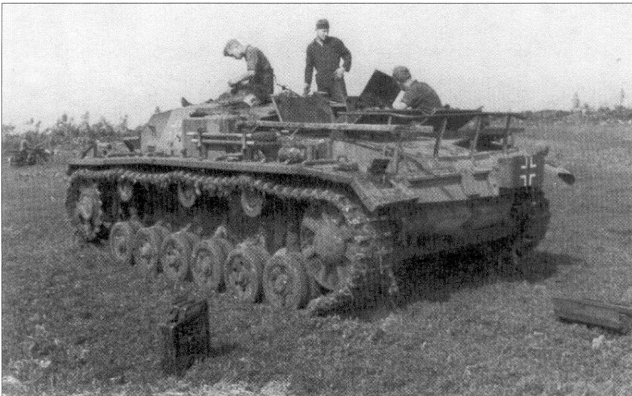
Вид сзади на штурмовое орудие модели Ausf. B. Судя по ведущим колесам нового типа и наличию бронекорпуса дымопускного устройства, эта машина - позднего выпуска. На корме укреплен рама для перевозки имущества экипажа. Обратите внимание на стоящую на переднем плане немецкую бензиновую канистру - такие же изделия и сейчас сильно распространены на территории бывшего Советского Союза.
