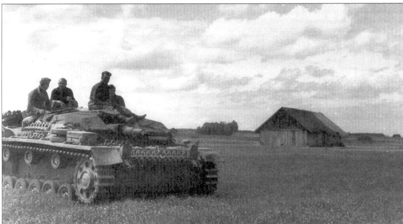
StuG III Ausf. В медленно движется по русскому полю, июль 1941 г. Машина принадлежит 185-му батальону штурмовых орудий. Рубка самоходки прикрыта брезентом, чтобы пыль и дождь не проникали вовнутрь. Во время затяжной кампании в России машины стали «обрастать» различным дополнительным оборудованием - траками, катками, ящиками и т.д.
