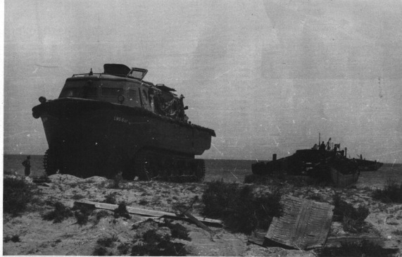
Die 21 Land-Wasser-Schlepper waren teilweise den Werftkompanien der Landungspionierbataillonen zugeteilt. Eingesetzt wurden die Fahrzeuge vornehmlich auf dem östlichen Kriegsschauplatz, z. B. bei der Besetzung der Baltischen Inseln 1941. Der LWS sollte auf dem Land als Zugmaschine und im Wasser als Motorschleppboot Verwendung finden. Für diese Aufgaben rüstete man das Fahrzeug mit einer leistungsfähigen Winde aus (BA)
