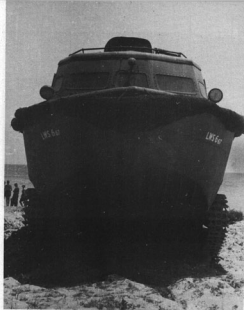
Seiten- und Frontansicht des Land-Wasser-Schleppers, der eine Besatzung von 20 Mann aufnahm. Die Kühlluft für den Dieselmotor wurde über den hinteren der beiden am Dach erkennbaren Schächte angesaugt. Der vordere ist ein Abluftschacht des Fahrzeuges mit einem 9,3 PS leistenden Ventilator. An den Seiten sind Ausrüstungsgegenstände wie z. B. Taue befestigt. Es wurden 7 Prototypen gefertigt, die größere Frontscheiben als die späteren Fahrzeuge aufwiesen und 1940 eingehend erprobt wurden. Später wurden 14 weitere Land-Wasser-Schlepper gebaut. Die Bilder zeigen dieses spätere Fahrzeug (3 x BA)
