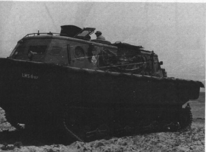
Seiten- und Frontansicht des Land-Wasser-Schleppers, der eine Besatzung von 20 Mann aufnahm. Die Kühlluft für den Dieselmotor wurde über den hinteren der beiden am Dach erkennbaren Schächte angesaugt. Der vordere ist ein Abluftschacht des Fahrzeuges mit einem 9,3 PS leistenden Ventilator. An den Seiten sind Ausrüstungsgegenstände wie z. B. Taue befestigt. Es wurden 7 Prototypen gefertigt, die größere Frontscheiben als die späteren Fahrzeuge aufwiesen und 1940 eingehend erprobt wurden. Später wurden 14 weitere Land-Wasser-Schlepper gebaut. Die Bilder zeigen dieses spätere Fahrzeug (3 x BA)
