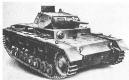
Die drei Ausführungen B, C und D sind leicht durch die Anordnungen der Blattfedern zu unterscheiden.
