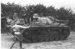
Oben und unten je eine Ausführung M. Es ist derselbe Panzer mit einer interessanten im Eigenbau gefertigten Halterung für Gepäck auf dem Heck.
