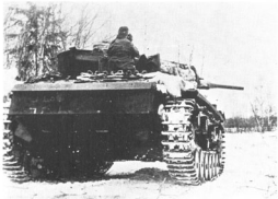
Links oben: Panzer und Grenadiere in der Steppe Südrußlands. Nach dem Triebrad (runde statt ovale Löcher) ist er eine Ausführung G.
