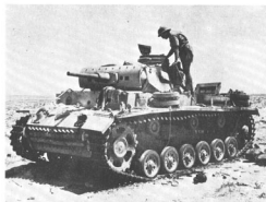
Oben: Ebenfalls ein Pz III/J mit Schottenpanzerung, aber ohne Schürzen, die er wegen der fehlenden Halterungen auch wohl nie getragen hat. (Afrika).
