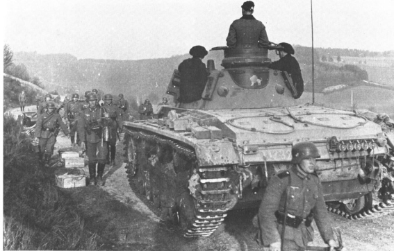
Ein Panzer III/F mit einem inoffiziellen Verbandsabzeichen am unteren Teil der Kommandantenkuppel. Ab der Ausführung G gibt es diese Ausbuchtung am Turmheck nicht mehr. Auch am Periskop auf dem Turmdach (neben dem linken Besatzungsmitglied und dem Kommandanten sichtbar) ist zu erkennen, daß es eine Ausführung F ist; G zeigt dieses Türmchen nicht mehr. Das Nebelabwurfgerät ist geladen.
