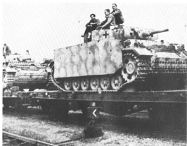
Oben: Ebenfalls ein Pz III/J mit Schottenpanzerung, aber ohne Schürzen, die er wegen der fehlenden Halterungen auch wohl nie getragen hat. (Afrika).
