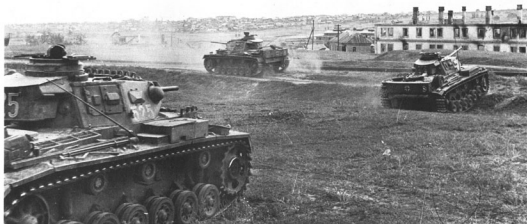
Linke und diese Seite zeigen den Panzer III/J mit der langen 5 cm KwK (L/60). Linke Seite Panzer des Panzer-Regiments 11 (6. Panzer-Division); diese Seite Panzer des Panzer-Regiments 24 (24. Panzer-Division). Die Hauptunterschiede zur Ausführung L sind: Bei L fehlen die seitlichen Lüftungsklappen im Turm und L zeigt meist vorn die Schotterpanzerung und Seitenschürzen. Wie sollte es aber anders sein? Auch J gibt es ohne Lüftungsklappen (letzte Bauserie) und J und frühere gibt es auch mit Schottenpanzerung und Seitenschürzen. Interessant die unterschiedlichen Lüftungsklappen. Auf der linken Seite glatt, auf dieser mit Sechsschlitze. Diesen Unterschied gab es auch bei früheren Ausführungen.
