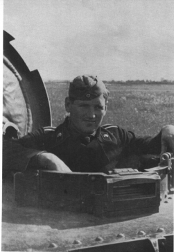
Panzerkommandant Unteroffizier Sprenger der 1./Pz.Abt. 65 im Turmeinstieg seines Skoda 35 (t). Gut zu erkennen sind die Nieten und im Turmdeckel das Lederpolster. In ihm blieb manch Geschöß oder Splitter stecken, wenn der Deckel nicht rechtzeitig geschlossen werden konnte. Die Nieten zeigten sich als ungünstig, wenn ein stärkeres Panzergeschöß schräg die Panzerplatten traf und diese zum Federn brachte. Die hierdurch abgebrochenen Nieten flogen im Kampfraum herum und trafen die Besatzung.
