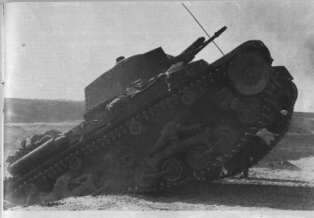
Dieser Panzerkampfwagen war eine Entwicklung der berühmten Skoda-Werke in Pilsen (Tschechoslowakei) und zeichnete sich durch fortschrittliche Konstruktion aus. Die deutsche Wehrmacht übernahm nach Besetzung der Tschechoslowakei (1939) rd. 300 Wagen aus dem vorgefundenen Bestand.
