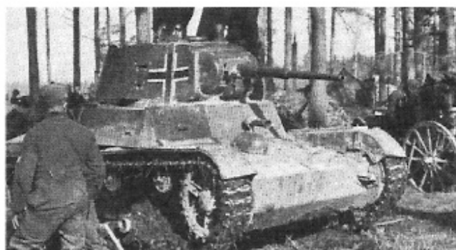
T-26S: La producción de la serie del T-26 alcanzó la cifra de 4.500 ejemplares. Aunque se dejaron de construir en 1939, se mantuvieron en servicio contra los alemanes hasta 1942 que fueron sustituidos por los T-60 y T-70 y destinados a misiones de segunda fila. Presentaba un blindaje inclinado que le daba mayor protección.
