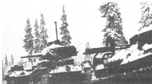
T-40: El T-40 fue ideado como vehículo de reconocimiento. Llevaba un motor poco potente para su peso en comparación con otros tanques soviéticos. Tenía un blindaje muy débil y un armamento eficaz sólo contra medios poco protegidos. Llevaba una hélice trasera que le permitía avanzar a una velocidad de 5 Km/h por el agua.
